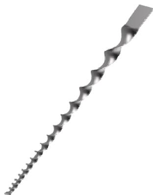
Рис. 4. Конструкция завихрителя
