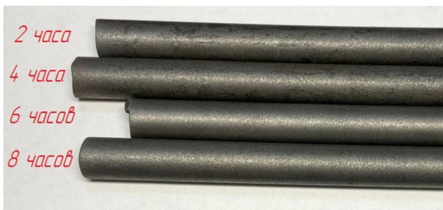
Рис.2. Исследуемые образцы после вибрационной сухой обработки
