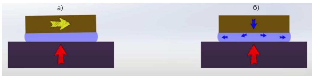
Рис. 1. Виды воздушных опор:
