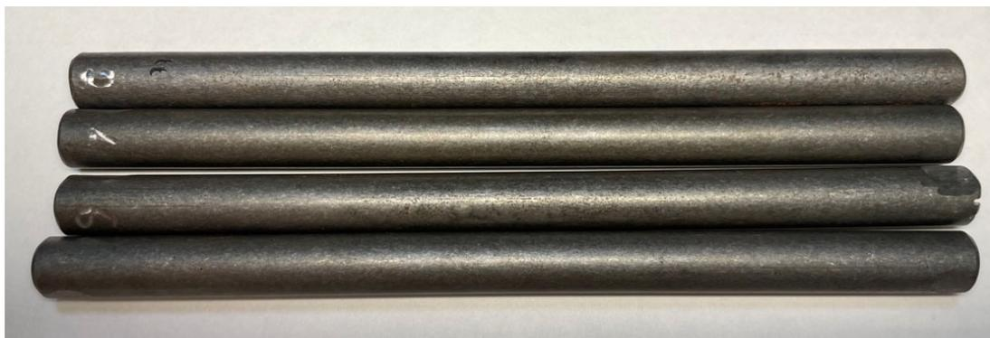
*Рис. 3.* Исследуемые образцы после вибрационной мокрой обработки
