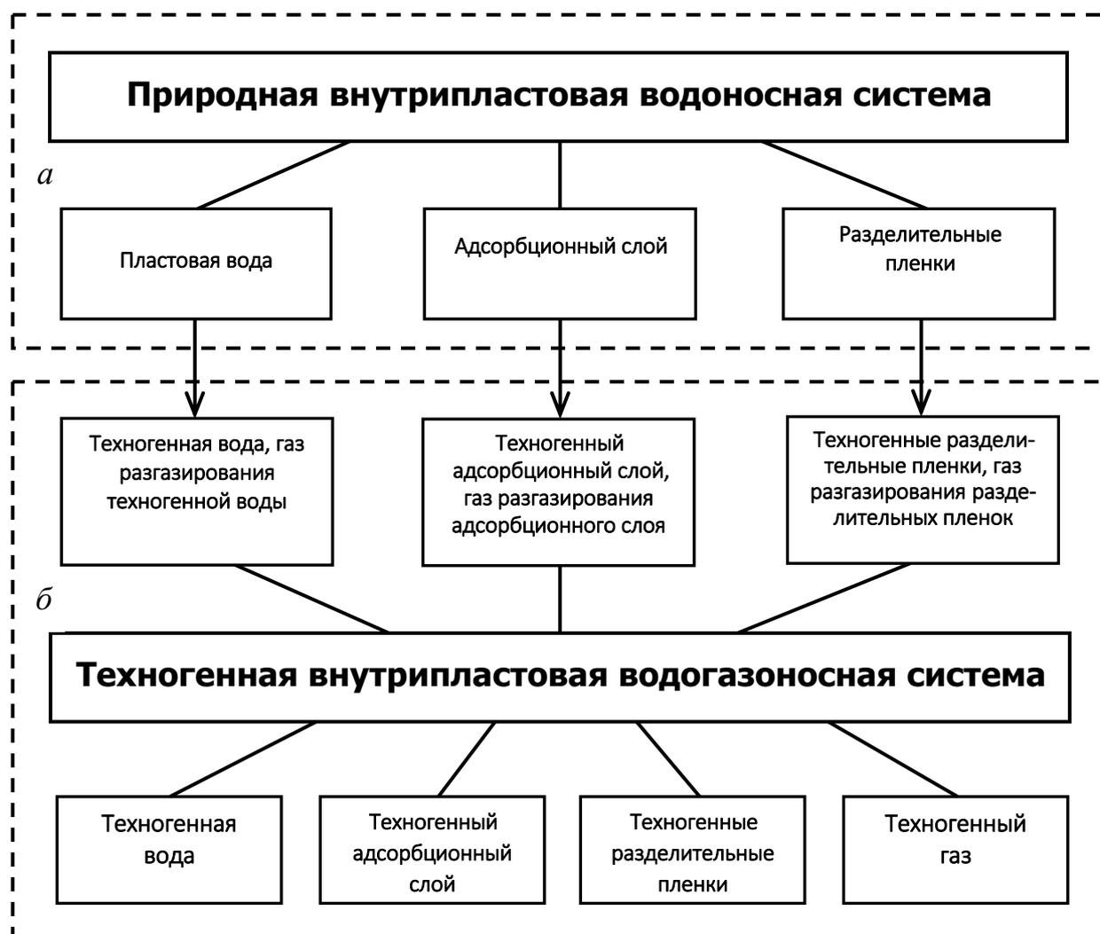
Взаимодействующие объекты внутрипластовых водоносных систем в гидрофобном коллекторе: *a* – до техногенного воздействия; *б* – в процессе техногенного воздействия
